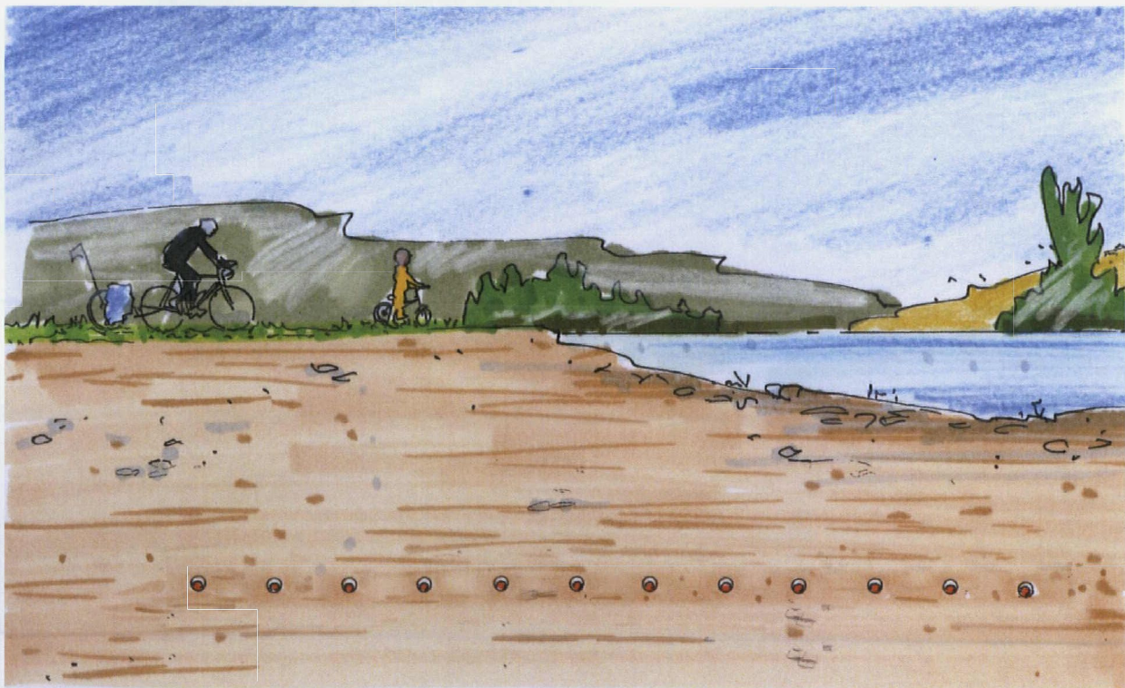
Abbildung 16: Situation nach dem Bau einer Horizontal-Spülbohrung. Für zwölf Kabel nebeneinander ist eine grosse Breite notwendig.
