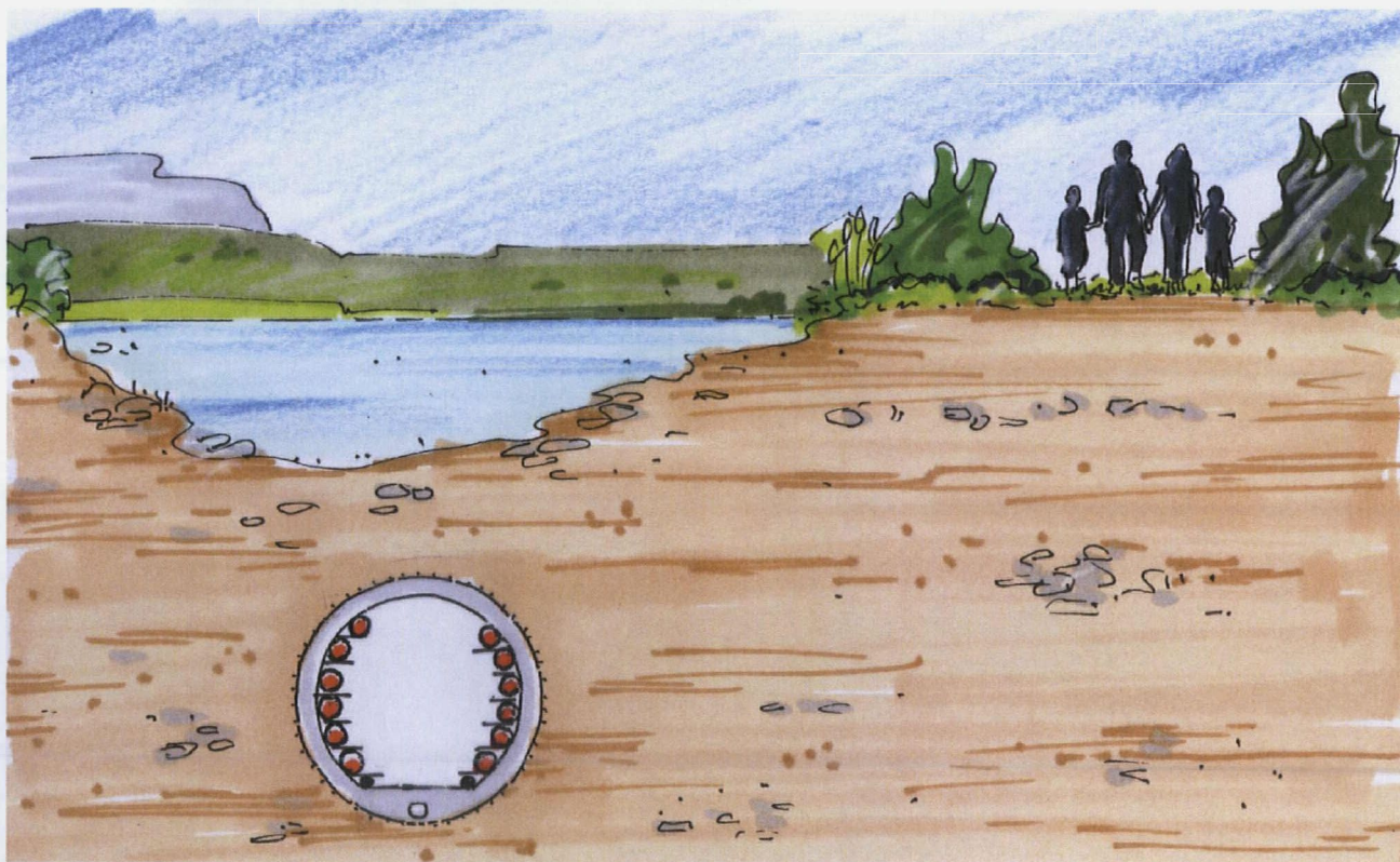
Abbildung 18: Darstellung einer Unterquerung eines kleinen Gewässers mit einem Mikrotunnel
