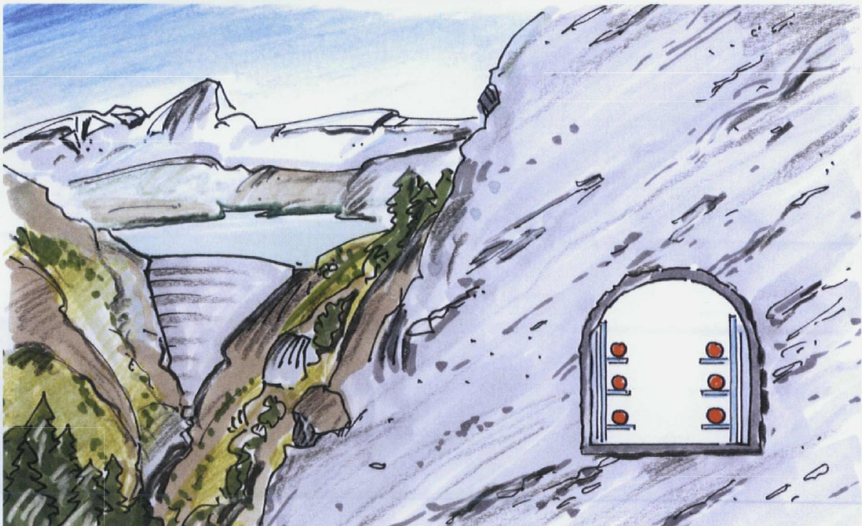
Abbildung 20: Ein Tunnel in alpinem Gelände für eine schwache Kabelleitung. Für eine Kabelleitungen mit einer hohen Transportkapazität sind zwei Tunnels notwendig.
